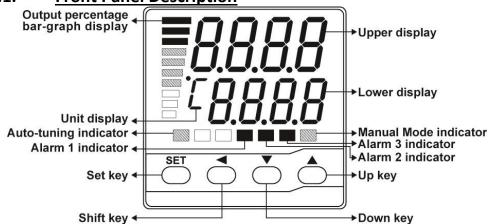
**PV Display** : Displays the process Value or parameter index code or error code
